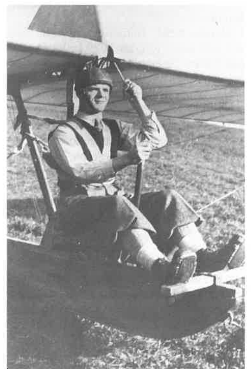
Der „Stamer-Lippisch-Zögling“. Besondere Beachtung verdienen das Seitenruder-Pedal und die improvisierte Aufhängung der Anschnallgurte.
