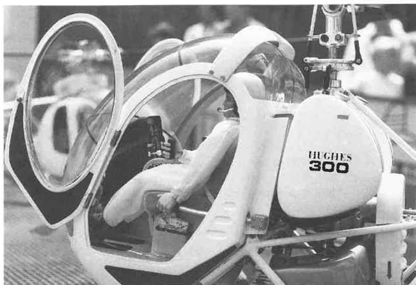
Maßstabgetreuer Nachbau HUGHES 300 Rotordurchmesser: ca. 120 cm Motor: 8 ccm, Gewicht: ca. 3,5 kg Erbauer: Leopold Köppl, Hallein, Salzburg.
